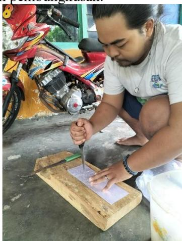
Gambar 2 Proses Pelubangan Plastik Kemasan
