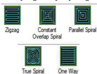
Gambar 1. Strategi Toolpath pada proses pocket milling yang disimulasikan di Mastercam.
