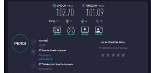
Gambar 27. Hasil Uji Throughput Download dengan Speedtest
