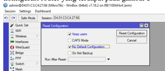
Gambar 4. Tampilan Menu Reset Configuration Pada WinBox
