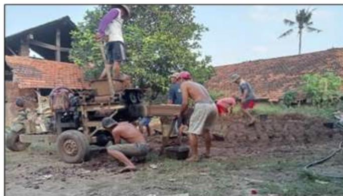
Gambar 5. Proses penggilingan tanah liat
