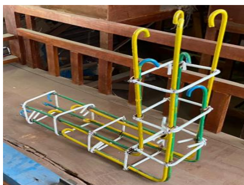
Gambar 1. Alat Peraga Tulangan Kolom-Sloof
