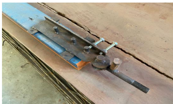
Gambar 2. Alat Pembengkok Tulangan Portable
