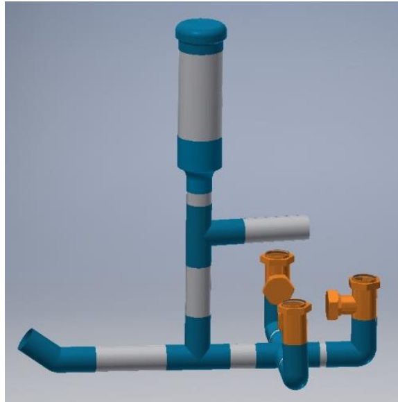
Gambar 7. Desain Pompa Hidram (Hidraulik Ram).
