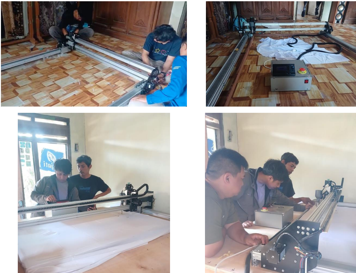
Gambar 3. Perakitan dan Uji Coba CNC Canting Batik
