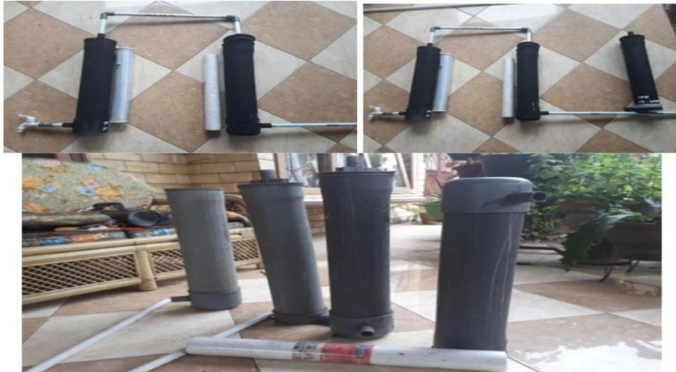
Gambar 1. Hasil Perancangan Awal Produk Prototipe Alat Penjernih Air yang sudah dirancang untuk Kapasitas
