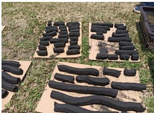
Gambar 6. Hasil Penyetakan Briket Dijemur Agar Kadar Air Berkurang
