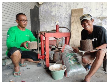
Gambar 4. Proses pencetakan bioblok kompos
