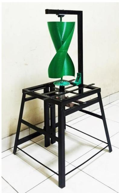
**Gambar 2.** Turbin Angin Poros Vertikal
