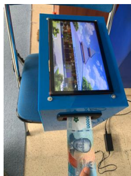
Gambar 6. Pengujian sistem kotak amal digital berbasis IoT
