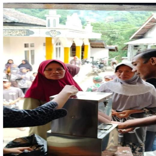
**Gambar 3.** Proses Pengupasan bawang Putih dengan Mesin Pengupas Otomatis
