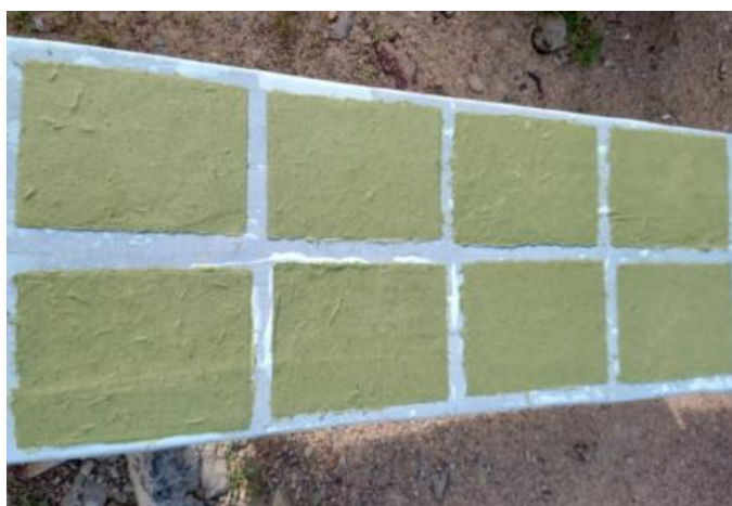
Gambar 5. Proses penjemuran kertas berbahan baku gulma dan batang pisang
