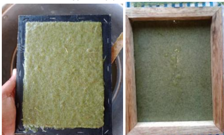
Gambar 4. Pencetakan bubur kertas (pulp) dengan alat pencetak ukuran A5
