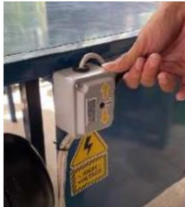
Gambar 7. Tuas Menghidupkan dan Mematikan Mesin
