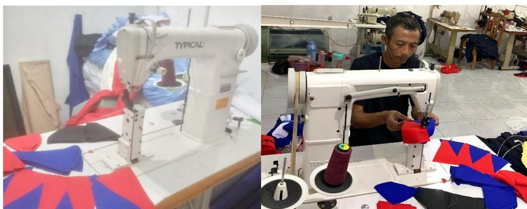
Gambar 7, Mesin jahit jarum tinggi untuk pembuatan totebag dan topi
