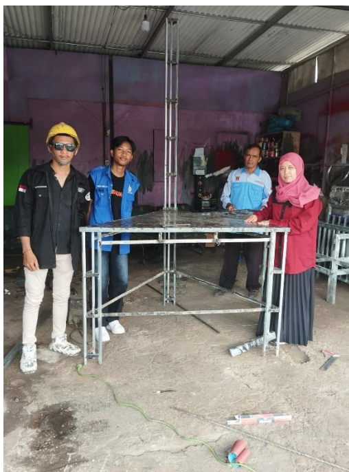
Gambar 5. Hasil kerangka alat peraga jack up rig yang terbuat dari limbah besi baja.
