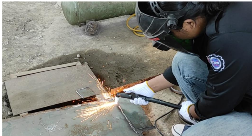
Gambar 4. Teknologi Plasma Cutting untuk Memotong limbah Besi Baja
