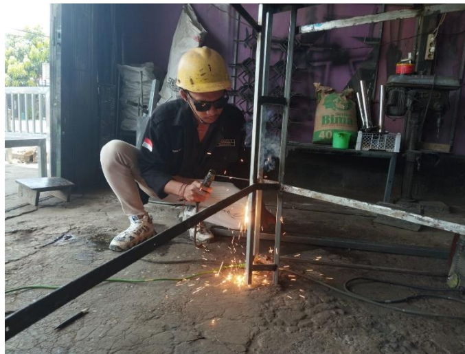
Gambar 5. Proses Pengelasan Alat Peraga Jack Up Rig Yang Terbuat Dari Limbah Besi Baja.
