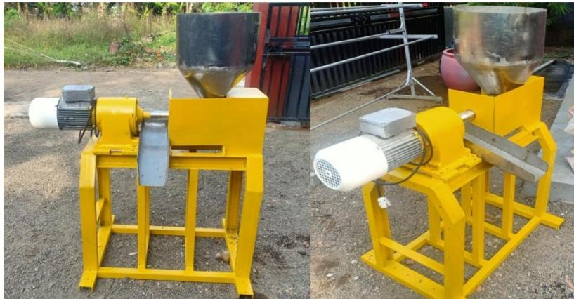
Gambar 3. Mesin Rice Bran Oil Generasi kedua kapasitas 100kg
