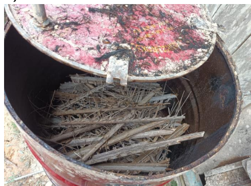
Gambar 3. Pelepah kelapa sawit pada ruang biomassa instalasi biochar
